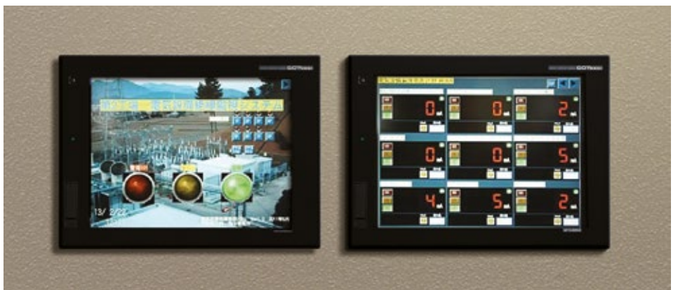
GOT上的主显示屏（左）和单个监控结果显示屏（右）。超过设置阈值的值将以黄色或红色亮起。
