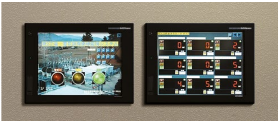
Главный экран (слева) и экран результатов индивидуального контроля (справа) на графической панели оператора. Значения, превышающие заданные пороговые уровни, помечаются желтым или красным цветом.
