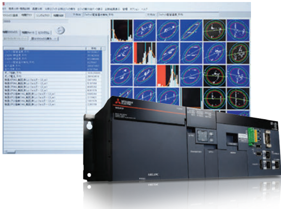
Mitsubishi Electric "MELIPC" Endüstriyel PC (sağda) üzerinde çalışan Real-time Data Analyzer (Gerçek Zamanlı Veri Analiz) yazılımı (solda) verileri toplayarak analiz eder ve durum/hata teşhisini gerçekleştirir.
