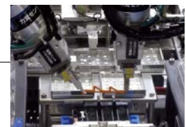
Cho phép hoàn thành công việc lắp đặt trong khi vẫn duy trì các vị trí kẹp giữa các robot.
